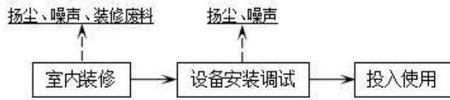
图 2-2 施工期流程及产污节点图
