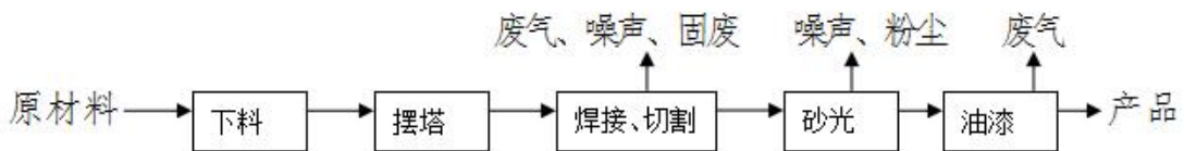
图 2-2 原有项目生产工艺流程及产污环节示意图
